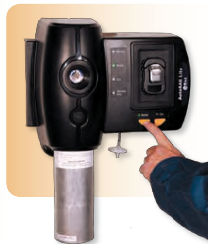
Een bump-test uitvoeren met de AutoRAE Lite
